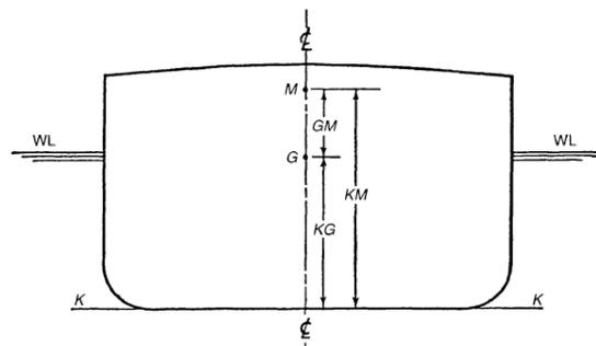
**Fig. 2.2. Transverse Metacentric Height**
